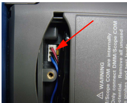
Figura 8-6 Desconecte el conector de tres cables con una pinza.
